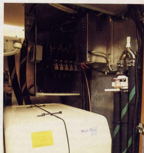
*A lato della sala macchine principale è ricavato un vano dove è installato il generatore e parte degli impianti di bordo. È un po' sacrificato.*
