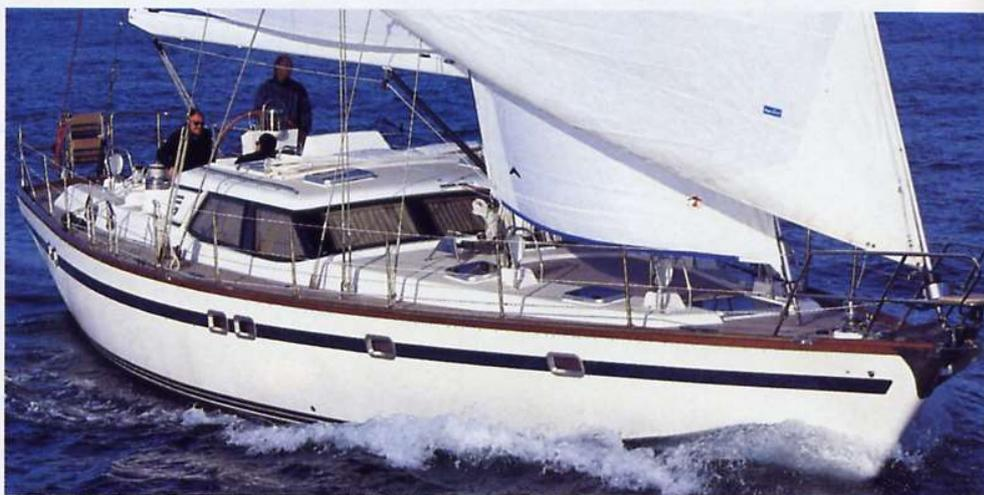
*Il Taswell 60 è caratterizzato da sezioni importanti e da entrate di prua piuttosto stellate che favoriscono il passaggio sull'onda. L'armamento a cutter, con yankee e trinchetta, risulta particolarmente utile per evitare le parziali riduzioni con l'avvolgifiocco, ma penalizza le prestazioni con venti leggeri.*
