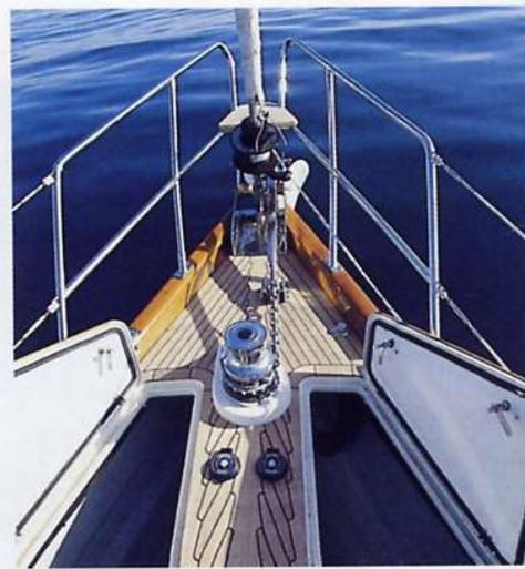
La cala dell'ancora è particolarmente ampia ed è provvista di doppia apertura. Può contenere la seconda ancora e i parabordi.
