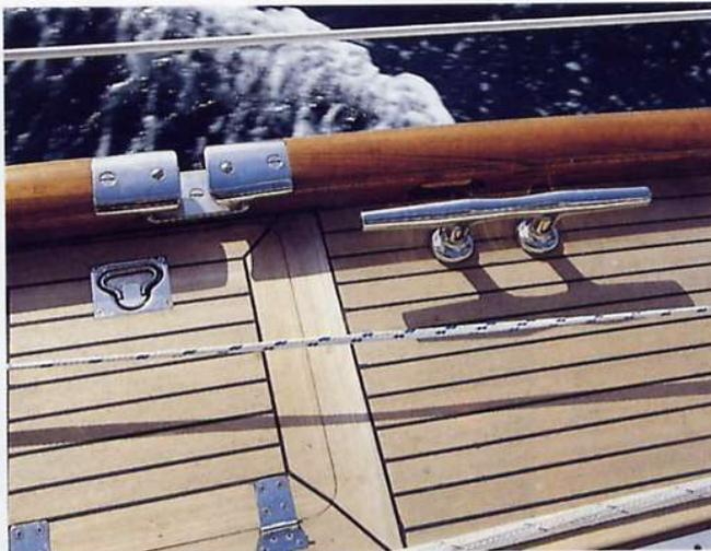
Questo particolare della falchetta in teak massello incoppalata con l'alloggiamento in acciaio per lo spring la dice lunga sul livello di finitura del cantiere. Il piccolo gavone contiene le bombole del gas.
