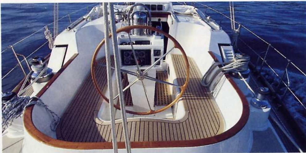
La bella ruota rivestita in legno è montata su una colonnina che accoglie la strumentazione del motore. Il pozzetto, molto pulito e privo di gavoni, misura cm 210x254. A portata del timoniere i quattro winch di scotta delle vele di prua e il trasto randa, munito di winch di recupero del circuito chiuso.
